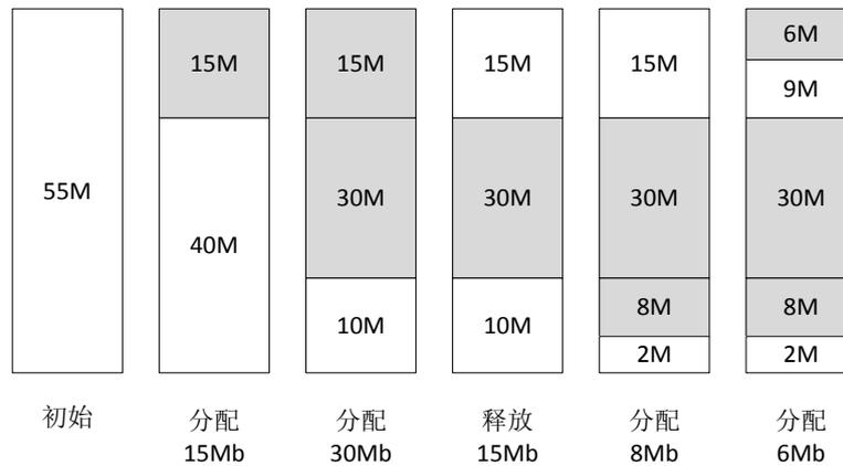
图 2010-28 最佳适配算法分配示意图
